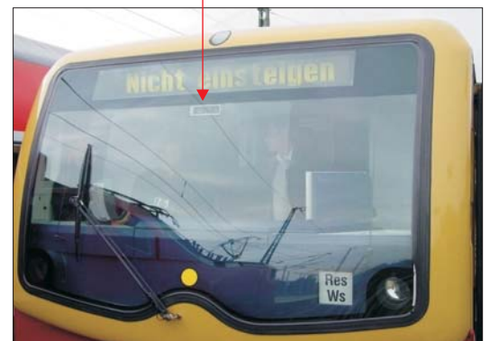
Sehr kleiner Optical Receiver hinter der Frontscheibe
